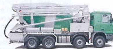
Questa soluzione viene utilizzata qualora si debbano usare quantità abbondanti di cemento in un cantiere che non è dotato di una betoniera fissa. Il bicchiere viene mantenuto in rotazione durante il trasporto; giunto in cantiere viene fatto ruotare in senso opposto e, sfruttando una coclea, il cemento risale le pareti e può fuoriuscire dalla sommità per essere gettato in opera.
