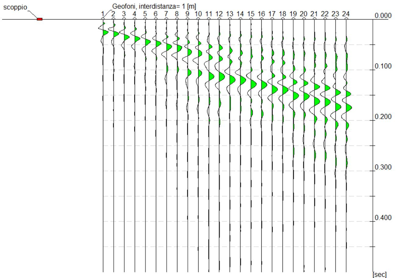
L'analisi spettrale del sismogramma sopra ottenuto, effettuata con l'ausilio del software specialistico *EasyMASW*, ha quindi consentito di trasformare il moto misurato dal dominio
