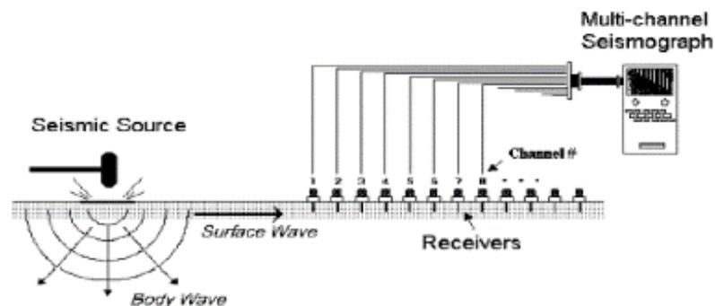
Tale metodologia, definita attiva, consente di ottenere una velocità di fase (*o curva di dispersione*) sperimentale apparente nel range di frequenze compreso tra circa 1 Hz e 60 Hz e, nel contempo, fornisce informazioni sulla parte più superficiale del suolo, generalmente compresa entro i primi 30 m di profondità.
