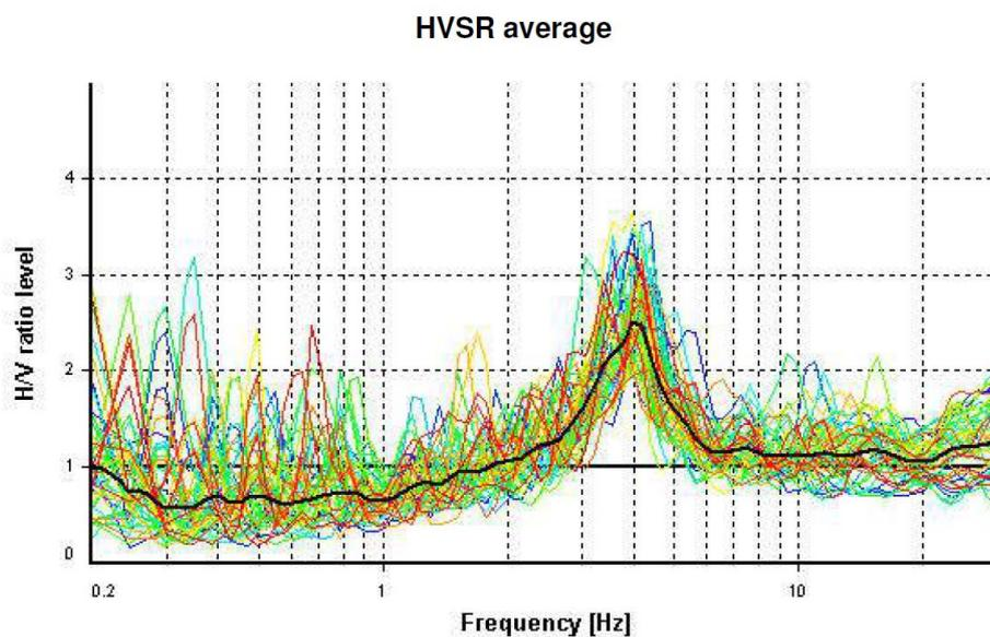
Le frequenze alla quali la curva H/V mostra dei massimi, sono legate alle frequenze di risonanza del terreno e l'ampiezza di questi massimi è proporzionale (*anche se non linearmente*) all'entità del contrasto di impedenza sismica esistente alla base della copertura.
