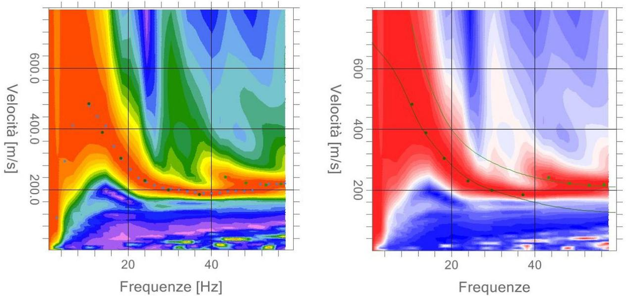
Effettuato il picking dei punti di dispersione, è stata eseguita l’inversione con il modo fondamentale e con quello superiore ed è stato ricostruito il modello “velocità  $V_s$  – profondità” che ha permesso di definire fino a 30 m di profondità le seguenti velocità delle onde di taglio:
