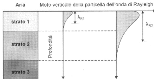
Il metodo MASW consiste nel registrare, con dei geofoni disposti lungo uno stendimento lineare e collegati ad un sismografo multicanale, le onde prodotte da una sorgente impulsiva che sbatte su un piattello metallico posto ad una certa distanza dal primo geofono.
