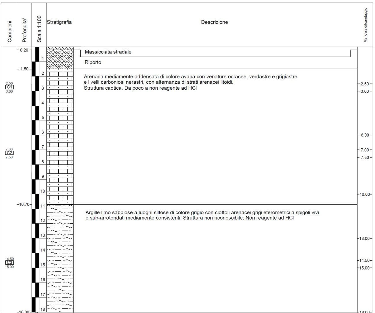
Le risultanze della perforazione, realizzata sul ciglio della strada, a lato della nicchia di distacco dello smottamento che ha interessato il margine esterno della carreggiata, hanno permesso di rilevare la presenza della componente sabbioso-argillosa della successione
