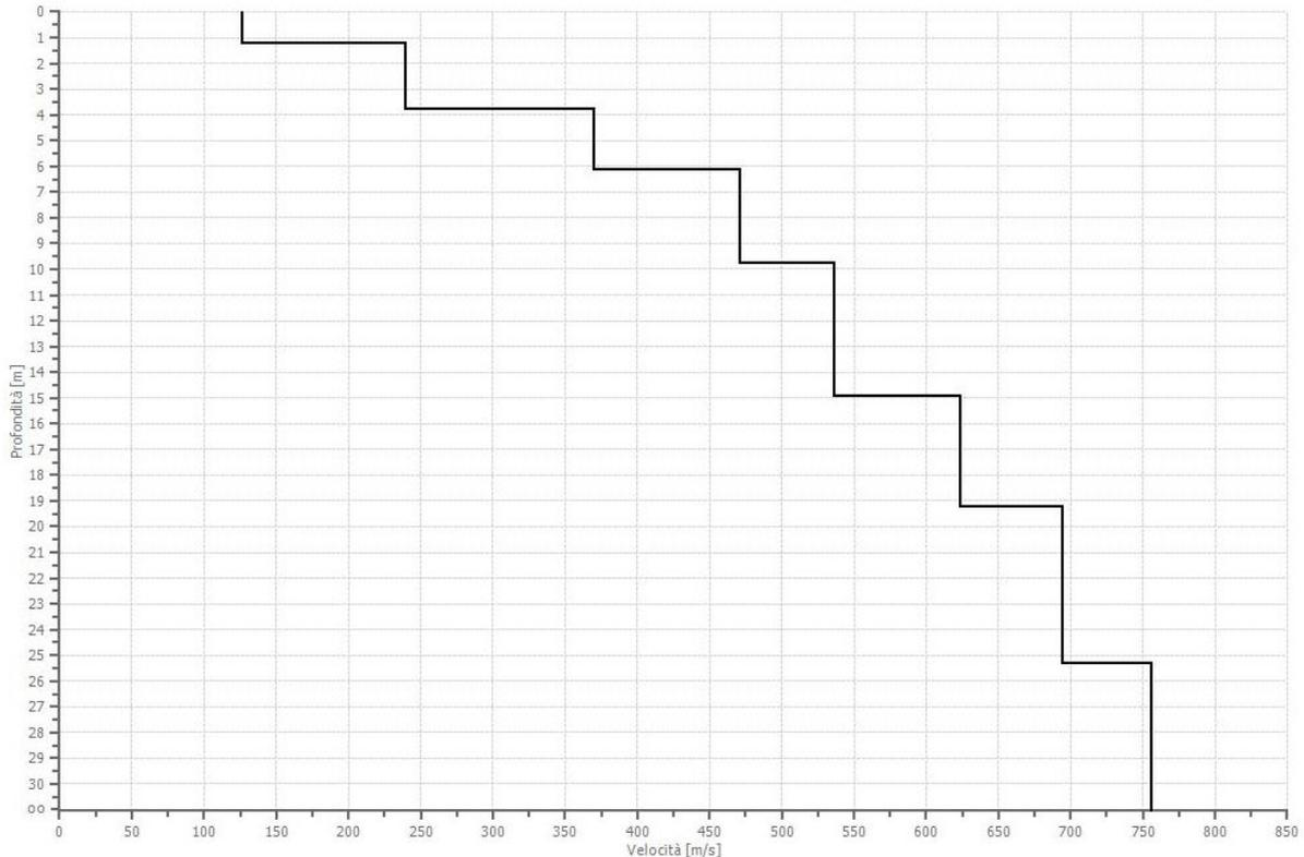
Considerata la variazione delle velocità delle onde di taglio con la profondità e tenuto conto del mancato rinvenimento del substrato con  $V_s > 800 \text{ m/sec}$  entro i primi 30 m dal piano di campagna è stato possibile definire un valore di  $V_{s,eq} = 453,87 \text{ m/sec}$  con  $H = 30.00 \text{ m}$ .
