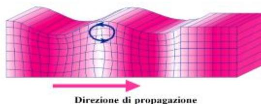
La velocità di propagazione delle Onde di Rayleigh ( $V_R$ ), anche se influenzata dalla velocità delle onde longitudinali ( $V_P$ ), dalla densità del mezzo attraversato e dal *Coefficiente di Poisson*, è funzione, soprattutto, della velocità delle onde trasversali ( $V_S$ ) rispetto alla quale risulta essere leggermente inferiore essendo  $V_R \approx 0,90 \times V_S$ .
