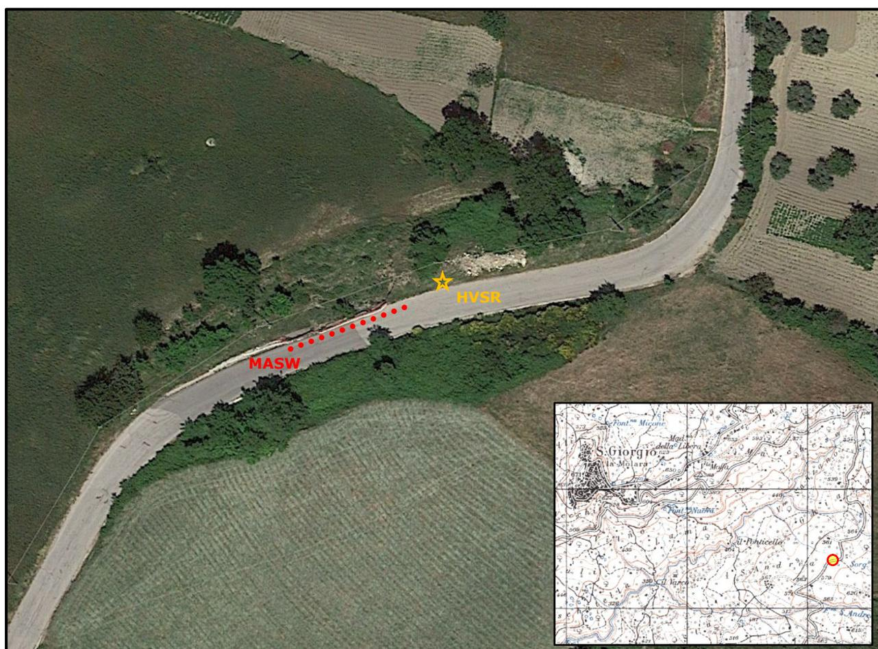
Le suddette indagini hanno permesso di determinare la velocità equivalente delle onde di taglio  $V_{s,eq}$ , necessaria per definire la categoria del suolo di fondazione secondo le Norme Tecniche per le Costruzioni NTC 2018, approvate con D.M. del 17/01/2018 e, nel contempo, di individuare la frequenza fondamentale di risonanza del sito.
