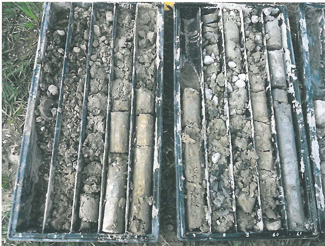
Foto n.°6: S. 2 cassette n°1-2 (da 0 a 11,00 m)
