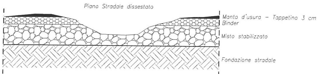
**Sezione stato di progetto - scala 1:20**
