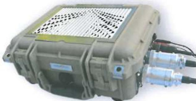
La gestione del sismografo avviene tramite software proprietario installato su laptop, tramite il quale è possibile gestire tutte le operazioni di campagna attraverso le seguenti fasi:
