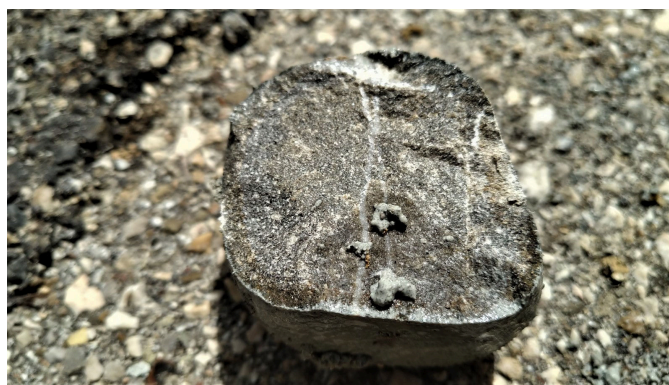
Fig. 16 – Sondaggio S2: ciottolo arenaceo silicizzato nel livello "5.00 – 9.20".
