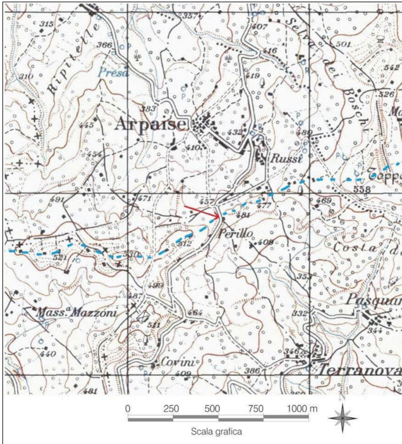
Fig. 1 – Contesto morfologico generale in cui è inserita l'area oggetto del presente studio. Il tratto di strada provinciale su cui è situato il muro da ricostruire è indicato con la freccia rossa ed è inserito in una zona di spartiacque (linea tratteggiata azzurra) allungata in direzione WSW-ENE e, in particolare la strada attraversa in trincea una sella che si sviluppa lungo lo stesso spartiacque. Stralcio della carta topografica IGM in scala 1:25.000; le maglie del reticolo UTM sono ampie 1 Km.
